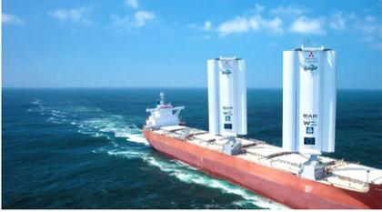
“O Pyxis Ocean, da Mitsubishi Corporation, e a serviço da Cargill, é o primeiro navio a ser equipado com dois WindWings. As \_\_\_\_\_ produzidas pela BAR Technologies em parceria com a Yara Marine possuem 37,5 metros de comprimento e são a promessa para a descarbonização.
